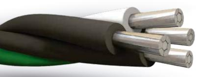
Conductor de aluminio AA (8000) para 0.6 kV aislados en polietileno reticulado (XLPE) resistente a la luz solar. Útil para ser enterrado directamente.
