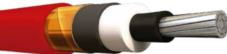
Conductor de aluminio para media tensión aislado con TRXLPE, apantallamiento con cinta de cobre (TS) o con hilos de cobre (WS) y chaqueta externa de policloruro de vinilo (PVC) resistente a la luz solar.
