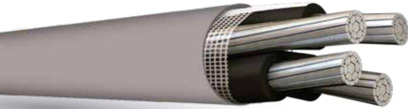
➤ Cable de acometida de aluminio AA (8000) para 0.6 kV tipo SE, estilo R. Conductores de fase individualmente clasificados como XHHW-2. Chaqueta externa de policloruro de vinilo (PVC) resistente a la luz solar.
